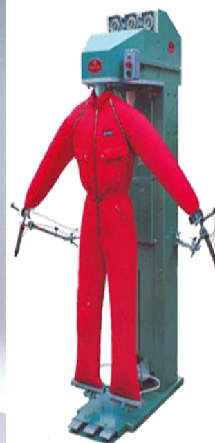
schéma a obrázok žehliacej figuríny nohavic.
